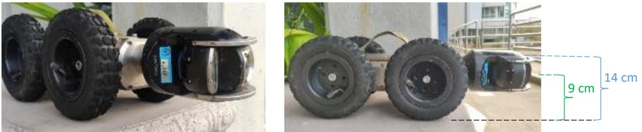
**Figura 2.** Configuración del equipo tractor empleada en la inspección de tubería en Calle Los Olivos.
