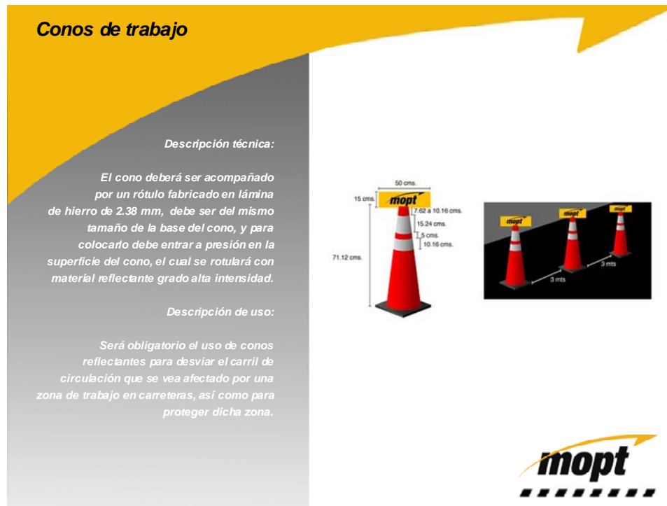
Ilustración 3. Descripción de los conos a utilizar. Fuente: Cartel de la Licitación Pública N° 2009LN-000003-CV “Proyectos de Conservación Vial Red Vial Nacional Pavimentada”.
