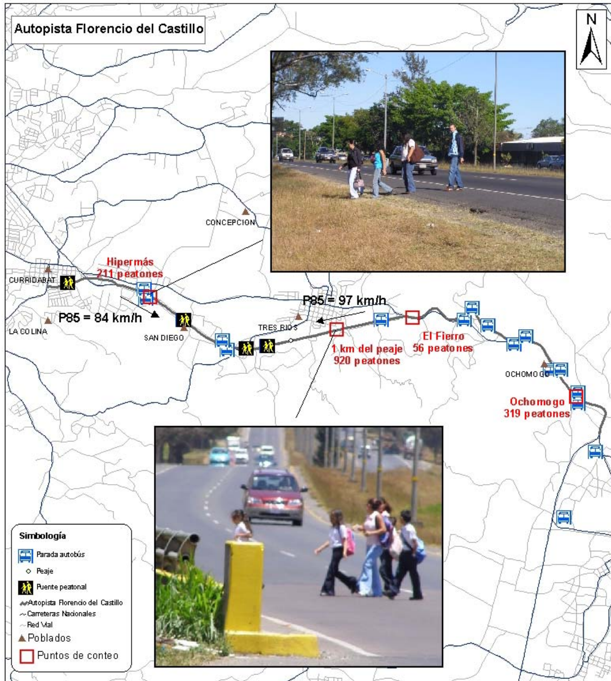
Figura A.2.2. Resultados de los conteos peatonales en la Autop. Florencio del Castillo
