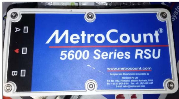
Figura 1. Contador de automóviles utilizado. (Pitra-LanammeUCR, 2016)
