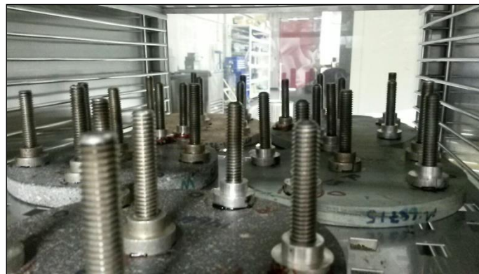
Figura N° 6. Muestras colocadas sobre el agregado.
