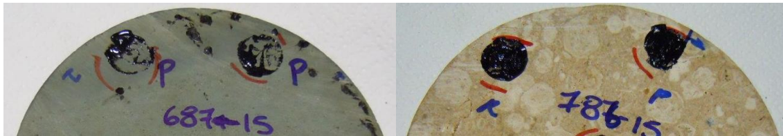
Figura N° 11. Análisis visual de la superficie obtenida tras realizar el ensayo. Fallo por cohesión a la izquierda y fallo por adhesión a la derecha.
