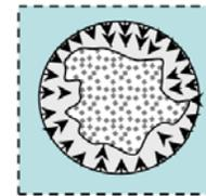
**Degradación del mortero asfáltico:** Proceso químico que ocurre posterior a otros eventos, en donde las capas superiores de la matriz asfáltica son sometidas a un proceso de lavado al estar expuestas a un flujo de agua constante. (15).
