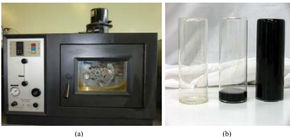
**Figura 10. Horno Rotatorio de Película Delgada. Los especímenes se colocan en posición horizontal, lo cual asegura que en la rotación todo el asfalto esté expuesto a las condiciones de aire y temperatura. (b) Recipiente de muestra**
