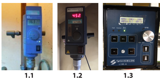
Fotografía 1. Mezcladores utilizados en el laboratorio para modificar. Los que se observan en las fotografías 1.1 y 1.2 pueden llegar a 2000 rpm. En la Fotografía 1.3 se observa un mezclador más sofisticado capaz de llegar a 6000 rpm y con su propio sistema de soporte. (Fuente: Lanamme, UCR)
