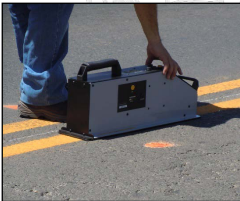
Figura 9.6. Medición de retrorreflexión con el equipo EASYLUX en el tramo de prueba, frente a la entrada principal del LanammeUCR.
