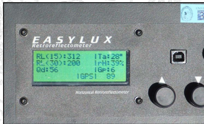
Figura 9.7. Pantalla del equipo EASYLUX, donde se indican los valores de retrorreflexión horizontal para las geometrías de 15 m y 30 m, así como el valor Q_D , la temperatura ambiente y el porcentaje de humedad relativa.
