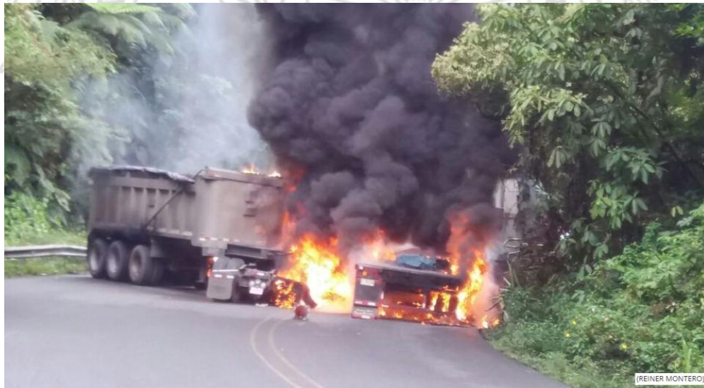
Figura 34. Se muestra el resultado de un accidente de tránsito en la Ruta Nacional No. 32 en abril de este año. Un incendio de este tipo sería muy difícil de controlar dentro del túnel. Equipamiento contra incendios y sistemas de comunicación cerca de la estructura facilitarían atender este tipo de emergencias dentro del túnel.
