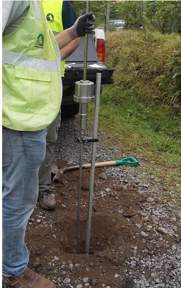
**Figura 22.** Prueba de DCP realizada en sitio
