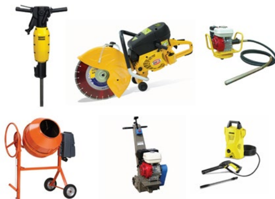
Figura 5. Maquinaria mínima utilizada en la reparación de espesor parcial
