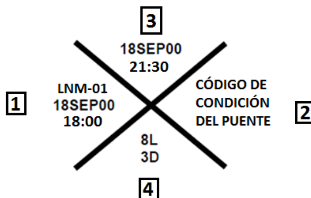
Figura 4.10. EJEMPLO DE MARCA QUE SE UTILIZARÁ PARA COMUNICAR EL ESTADO DE SEGURIDAD EN PUENTES. TOMADO DE FEMA (2006), MODIFICADA POR AUTORES
