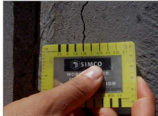
(b) Ejemplo de una grieta de 1,25 mm de ancho aprox.
