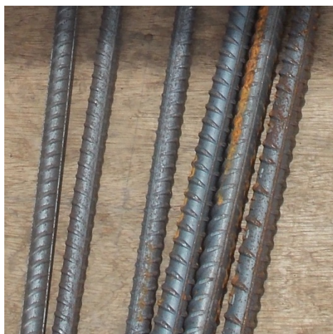
Fotografía 15. Muestras de acero de refuerzo.
