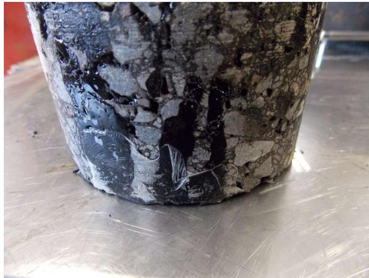
Fotografía 4. Escurrimento de emulsión asfáltica por los vacíos de la mezcla
