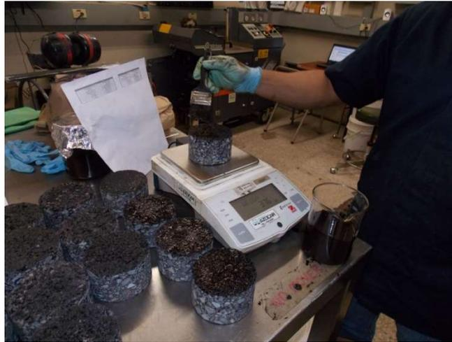
Fotografía 1. Aplicación de emulsión asfáltica en especímenes.
