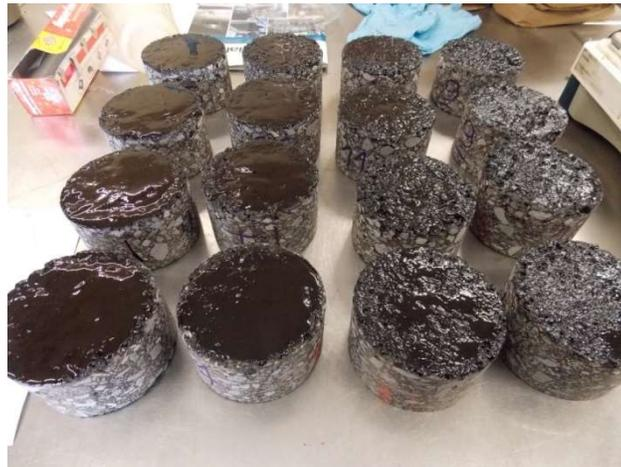
Fotografía 2. Especímenes con emulsión asfáltica.
