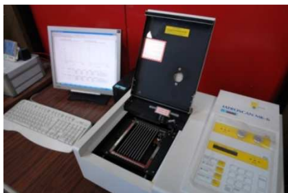
Figura 9. Equipo para Cromatografía Iatroscan (Fuente: LanammeUCR)
