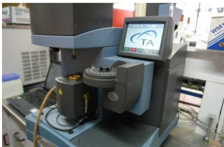
Figura 4. Equipo para Análisis Termogravimétrico (Fuente: LanammeUCR)
