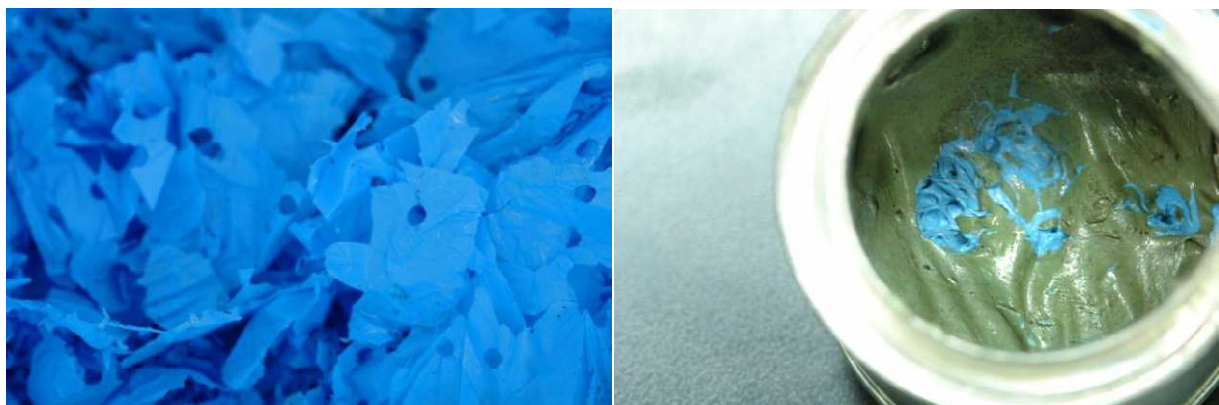
Figura 1. (a) Bolsa de banana procesada (b) Encapsulamiento del polietileno
