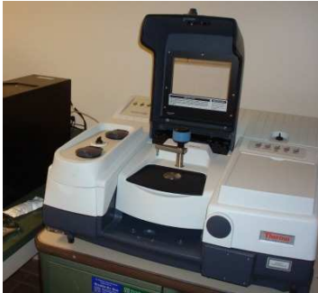
Figura 13. Equipo para Espectrometría Infrarroja
