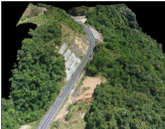
**Figura 6.** Ruta Nacional No. 27, km 47 control de taludes afectados por procesos de drenaje ácido de roca, Modelo Digital de Superficie, resolución 1m.
