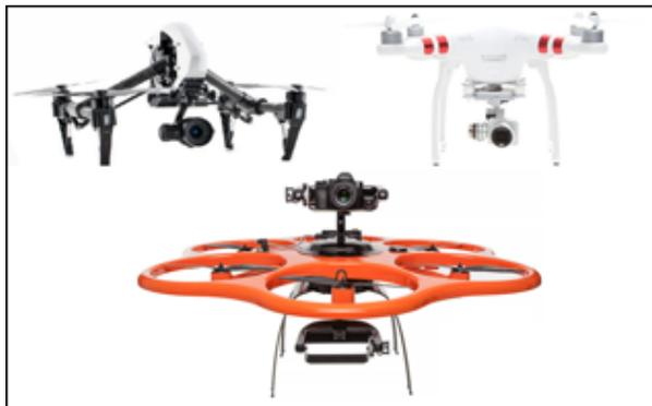
**Figura 2. Se muestran imágenes de los tres tipos de VANT con que cuenta LanammeUCR, arriba a la izquierda DJI Inspire Pro, arriba a la derecha Phantom 3 Professional y abajo Aibot v2 X6.**
