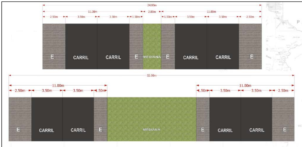
Figura 2 Secciones transversales típicas para la Red de Alta Capacidad. Nota: Tomado de INECO, (2011)
