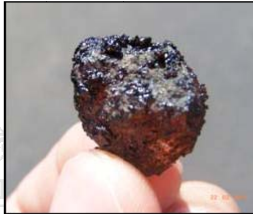
Fotografía 21. Material encontrado en la mezcla asfáltica de la tolva del distribuidor de mezcla.
