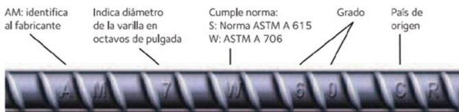
Figura 5. Identificación de una barra grado 420 [60] según la empresa ArcelorMittal
