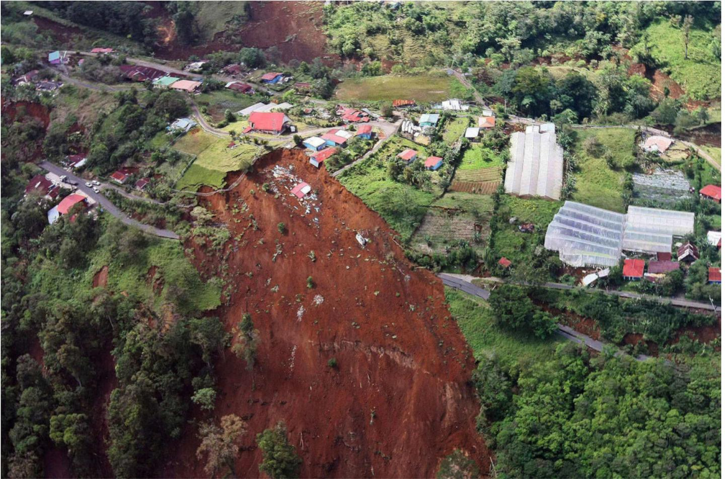
**Figura 1: Deslizamientos en Cinchona producto del terremoto del 2009**
