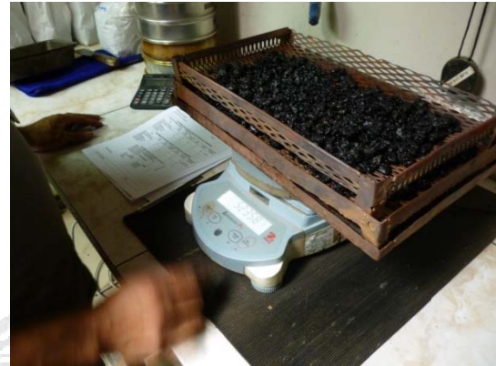
Fotografía 13: Contenido de asfalto
