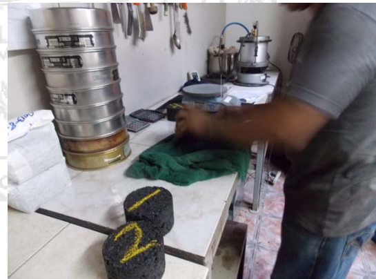
Fotografía 11: Gravedad Específica Bruta
