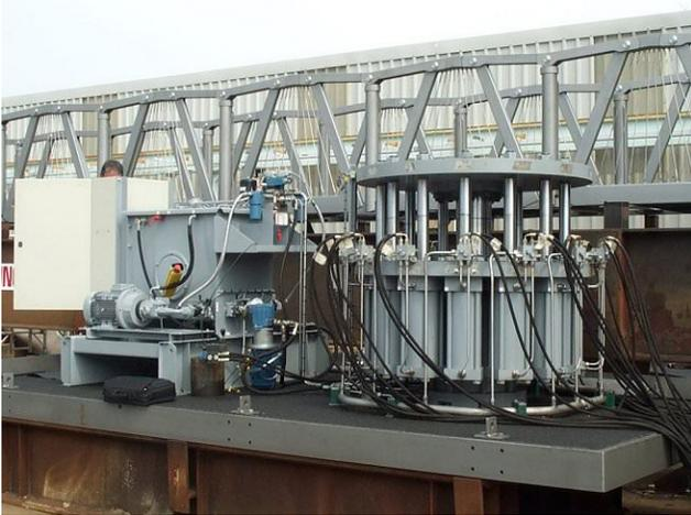
Figura 4. Equipo hidráulico, disposición del cilindro maestro y cilindros secundarios
