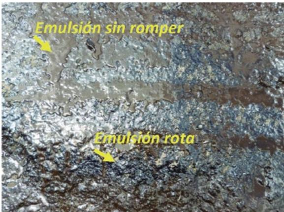
Figura 3. Rompimiento de emulsión asfáltica.
