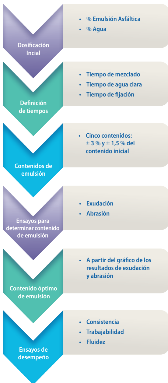
Figura 6. Procedimiento de diseño de una mezcla de lechada asfáltica. Fuente: LanammeUCR, 2011
