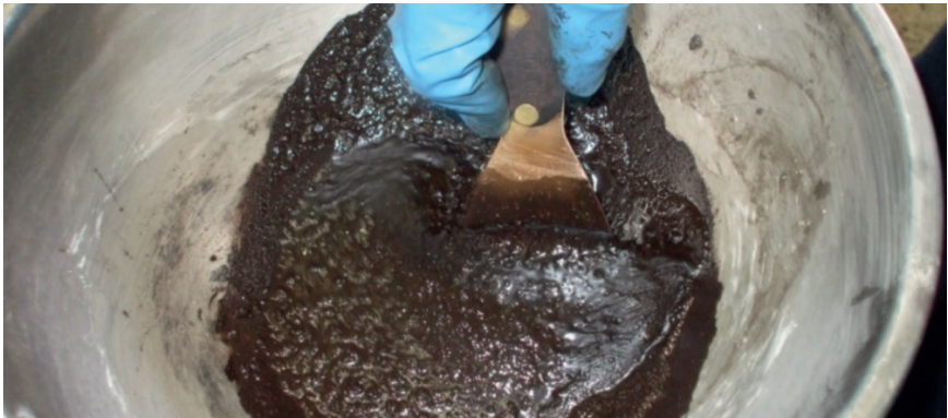
Figura 8. Prueba de trabajabilidad y fluidez.
