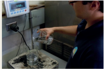
b. Medición por peso del agua
