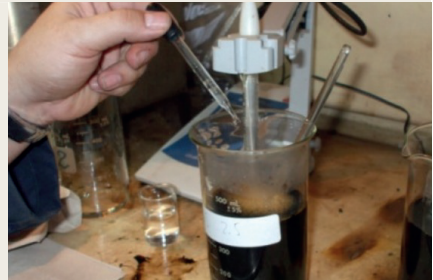
d. Adición de HCl, controlando el pH
