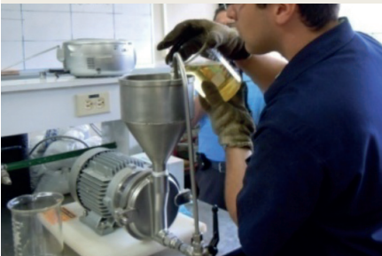
e. Limpieza y acondicionamiento del molino coloidal
