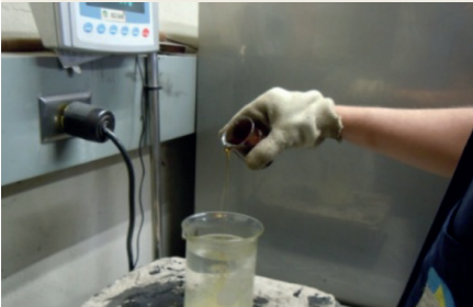
c. Adición del emulsificante para una CSS-1h
