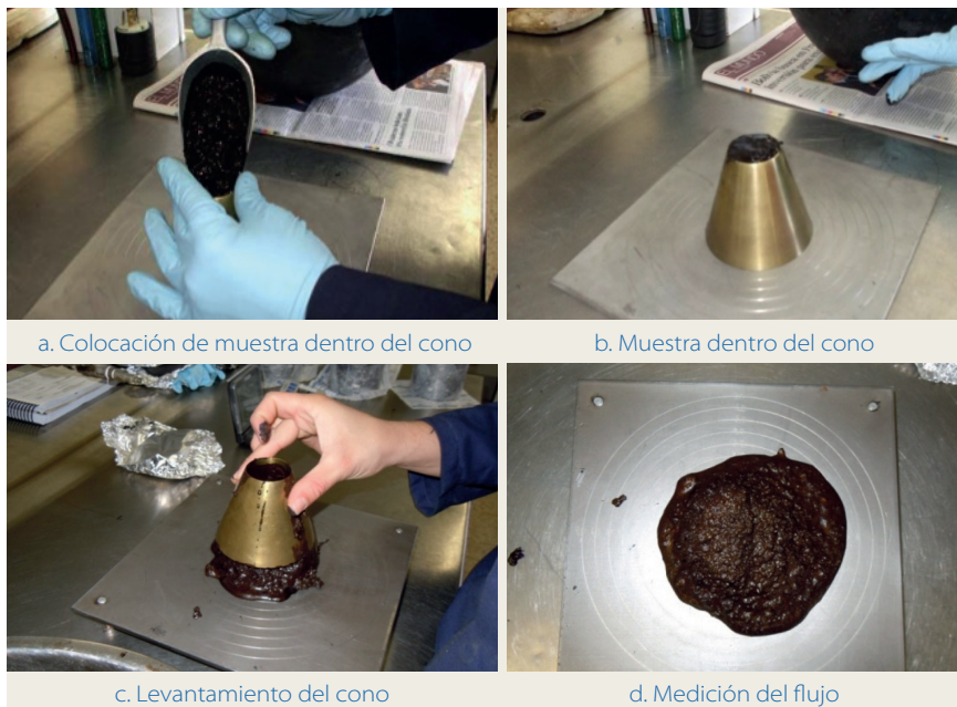
Figura 17. Ensayo de consistencia ISSA TB 106. Fuente: LanammeUCR, 2011
