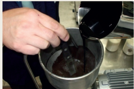
f. Mezclado de fase jabonosa y asfalto en el molino coloidal
