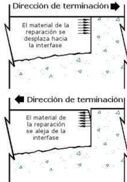
Figura 402-2. Terminación del concreto.
