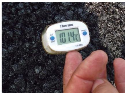
Ejemplo de medición de temperatura con un termómetro de espiga.
