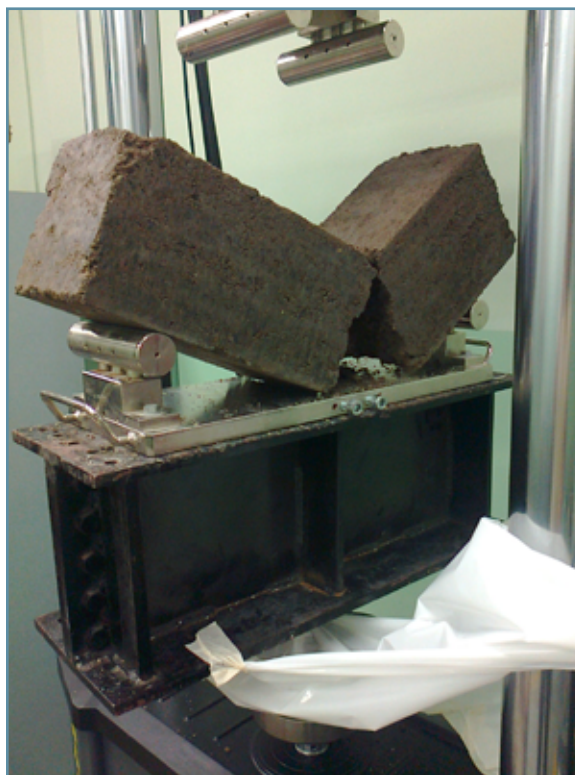
Fotografía 2. Falla de espécimen de base estabilizada con cemento. Fuente: Trabajo de Graduación, José Pablo Alfaro Martínez, 2015.
