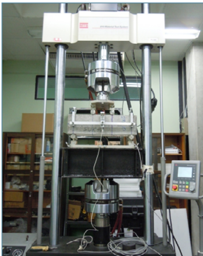
Fotografía 1. Montaje de ensayo de fatiga en concreto. Fuente: Trabajo de Graduación, Sukti Monge Morales, 2013.
