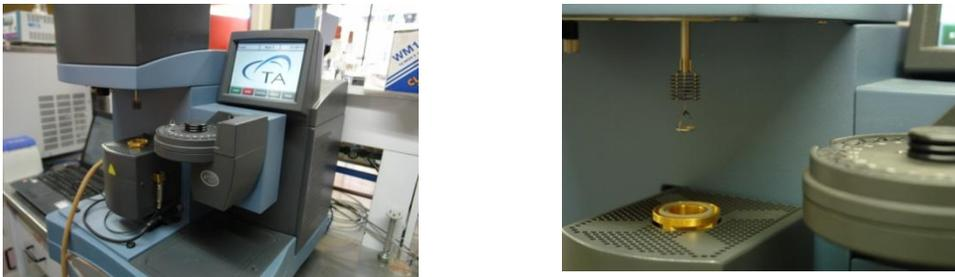
Figura xxx. Equipo para Análisis Termogravimétrico (Fuente: LanammeUCR)
