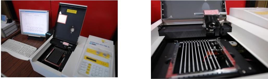
Figura xxx. Equipo para Cromatografía Iatroscan (Fuente: LanammeUCR)
