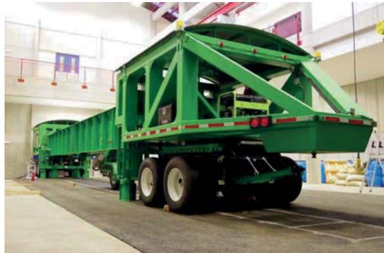
Figura 1 Equipo para ensayo de pavimentos a escala real del LanammeUCR, HVS Mark VI.
