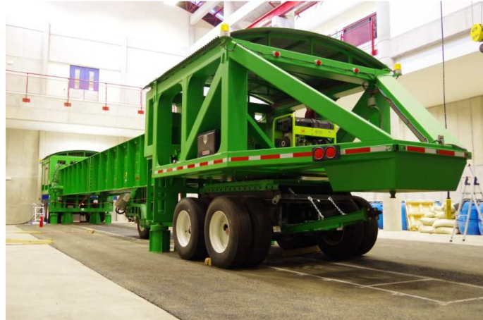
Figura 1 Equipo para ensayo de pavimentos a escala real del LanammeUCR, HVS Mark VI (Dynatest).
