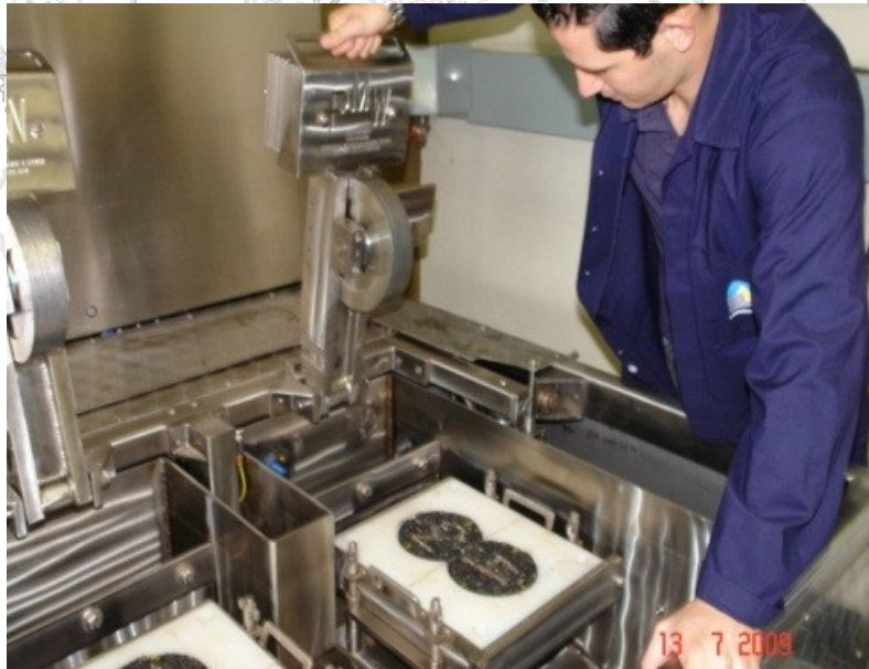
Figura 2. Ensayo de la Rueda de Hamburgo
