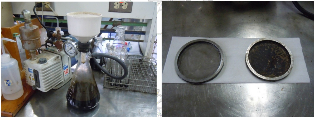
Figura 4. Propuesta del equipo para la determinación de polímeros en asfalto modificado.
