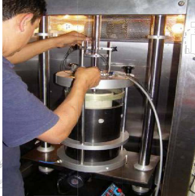
Figura 8. Ensayo de Módulo Resiliente.
