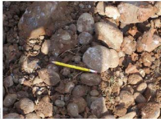
Fotografía N° 18: Ruta Nacional N° 752, San Bosco (Iglesia)-Santa Rosa (R.35). Estación 17+100. Material con sobre-tamaño y problemas de plasticidad.
