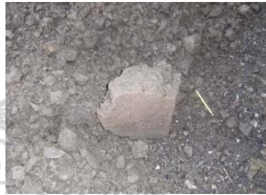
Fotografía N° 19: Ruta Nacional N° 152, Veintisiete de Abril (R.160)-Villarreal (R.155). Estación 11+500 a 12+000. Material con sobre-tamaño y problemas de plasticidad Fuente: Unidad de Auditoría Técnica, LanammeUCR. Visita 30 de julio del 2010.
