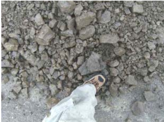
Fotografía N° 19: Ruta Nacional N° 152, Veintisiete de Abril (R.160)-Villarreal (R.155). Estación 11+500 a 12+000. Material con sobre-tamaño y problemas de plasticidad Fuente: Unidad de Auditoría Técnica, LanammeUCR. Visita 30 de julio del 2010.
