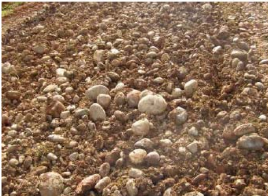
Fotografía N° 18: Ruta Nacional N° 752, San Bosco (Iglesia)-Santa Rosa (R.35). Estación 17+100. Material con sobre-tamaño y problemas de plasticidad.
