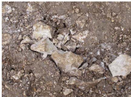
Fotografía N° 4: Ruta Nacional N° 925, Jabilla Abajo (R.1)-Lte. Cantonal Cañas/Tilarán (Río Higuierón Último Paso), Tramo entre 4+960 y 5+318. Material del Tajo San Buena, con sobre-tamaño, problemas de plasticidad (fotos superiores) y baja resistencia a la fractura ante el proceso de colocación y compactación (fotos inferiores).
