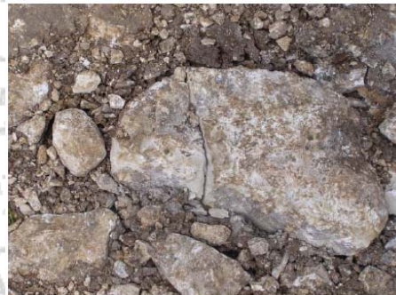
Fotografía N° 4: Ruta Nacional N° 925, Jabilla Abajo (R.1)-Lte. Cantonal Cañas/Tilarán (Río Higuierón Último Paso), Tramo entre 4+960 y 5+318. Material del Tajo San Buena, con sobre-tamaño, problemas de plasticidad (fotos superiores) y baja resistencia a la fractura ante el proceso de colocación y compactación (fotos inferiores).
