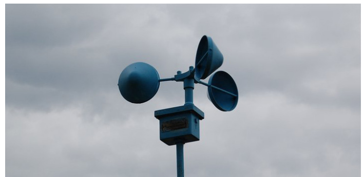
Figura 2. Anemómetro de 3 copas
