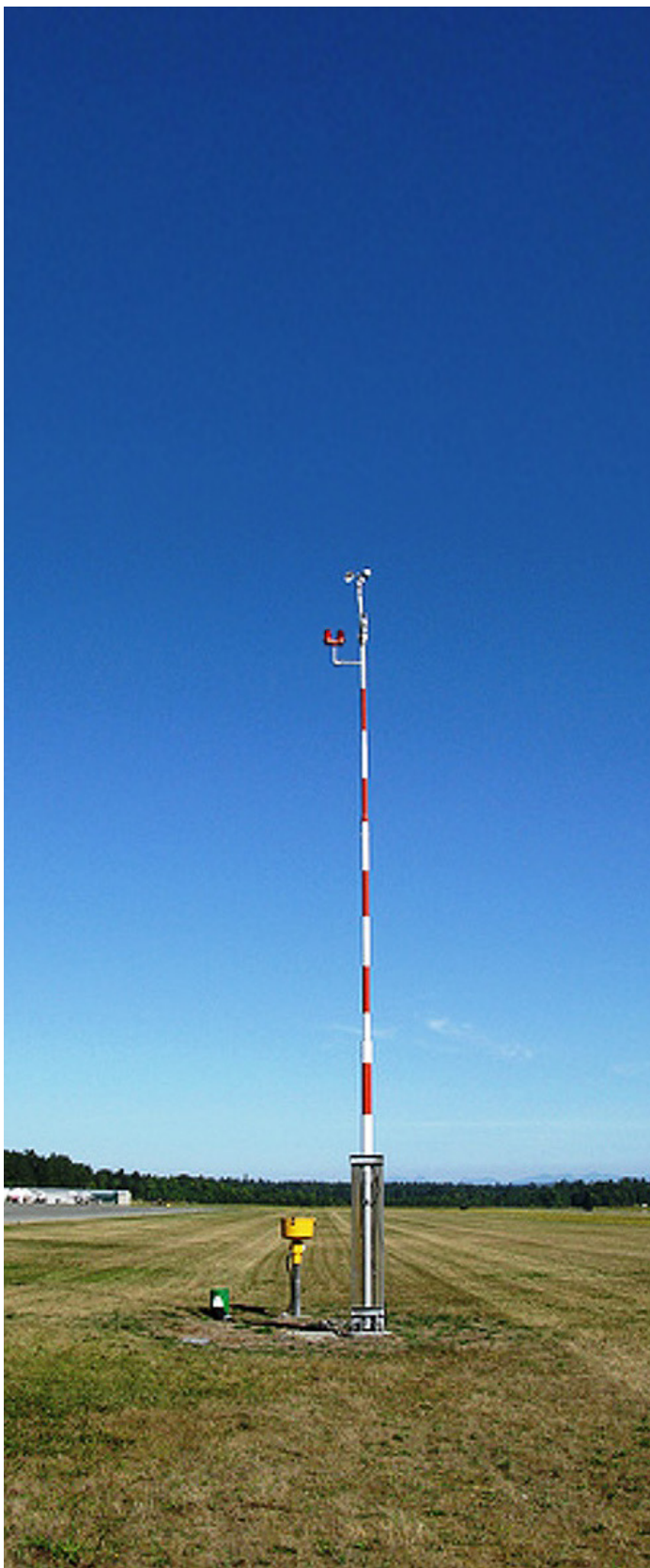
Figura 8. Anemómetro colocado a 10 metros de altura en terreno regular con baja rugosidad
