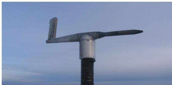
Figura 5. Anemómetro de presión o tubo Pitot http://www.accuweather.com/
