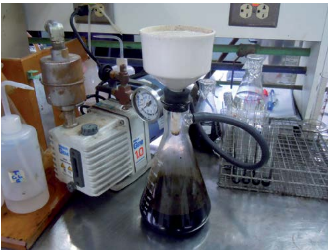
Figura 10. Detalle del equipo de PAT modificado, para determinar el contenido de polímero después de disuelto (imagen izquierda), colocación de la malla de 75 µm en el embudo Buhner.
