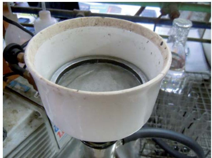
Figura 10. Detalle del equipo de PAT modificado, para determinar el contenido de polímero después de disuelto (imagen izquierda), colocación de la malla de 75 µm en el embudo Buhner.
