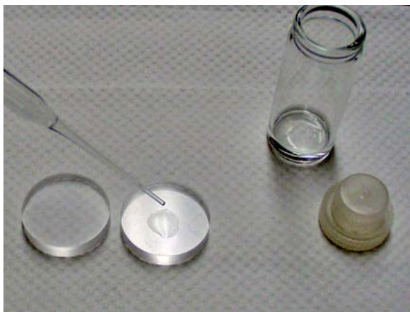
Figura 6. Detalle del método de placa de sal, incorporación de la muestra (imagen izquierda), placa de sal colocada en el paso óptico del FTIR. [11]
