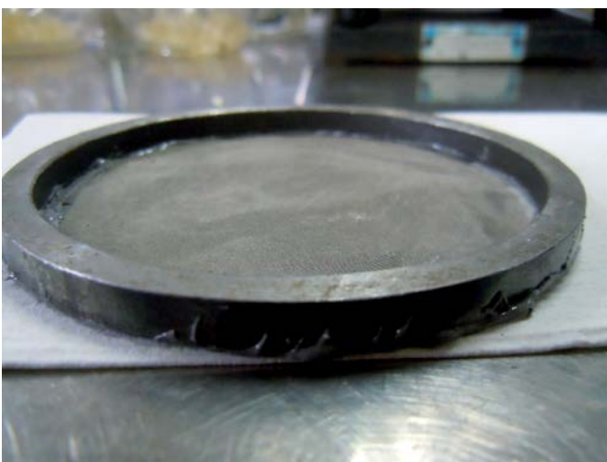
Figura 11. Detalle de la malla de 75 µm o malla N° 200 (imagen izquierda), recuperación de polímero tipo SBR en la malla (imagen derecha)
