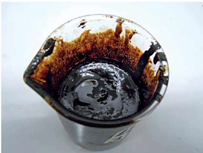
Figura 1. Fotografía de un asfalto modificado con polímero tipo SBS, la imagen muestra un caso de mala incorporación del polímero (presencia de grumos) en la matriz asfáltica.
