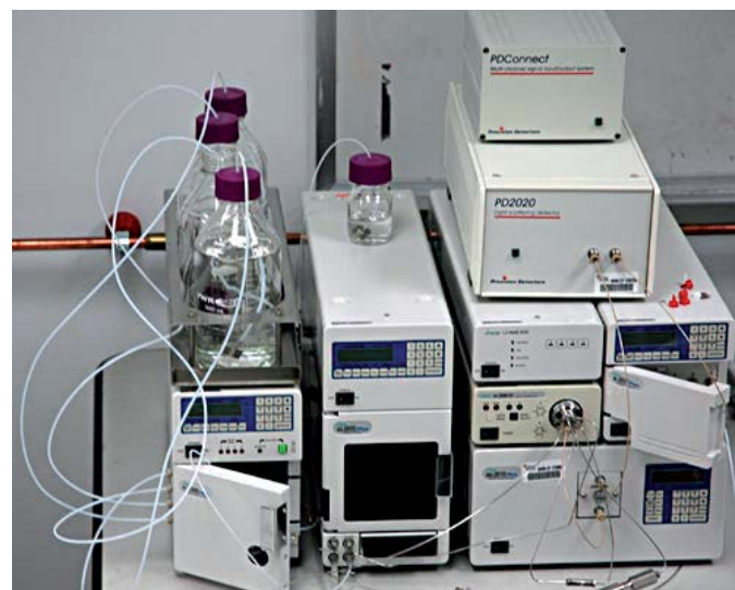
Figura 9. Detalle del equipo de GPC, la metodología para determinar el contenido de polímeros en ligantes asfálticos requiere adicional un detector de índice de refracción RID. [13]
