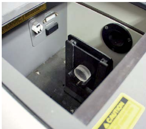
Figura 6. Detalle del método de placa de sal, incorporación de la muestra (imagen izquierda), placa de sal colocada en el paso óptico del FTIR. [11]
