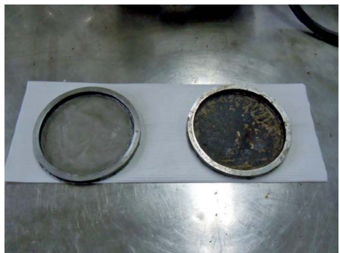
Figura 11. Detalle de la malla de 75 µm o malla N° 200 (imagen izquierda), recuperación de polímero tipo SBR en la malla (imagen derecha)
