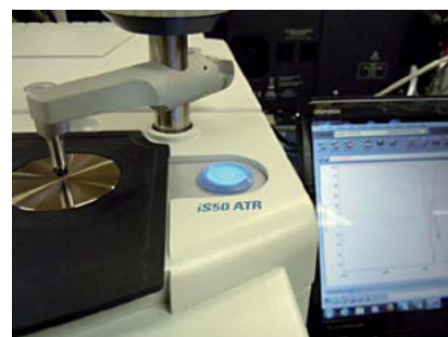
Figura 7. Detalle del método de FTIR-ATR, sistema con cristal de diamante (imagen a la izquierda), colocación de muestra en el cristal (imagen al centro) y determinación del espectro de la muestra de ligante asfáltico (imagen a la derecha).
