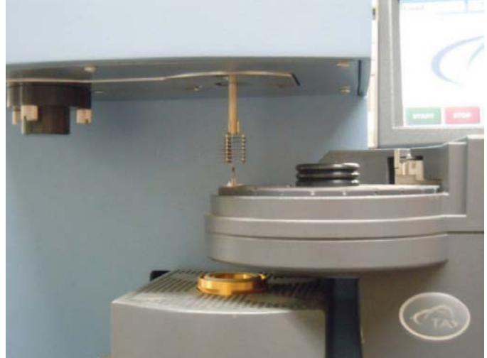
Figura 3. Transporte de la muestra desde la plataforma hasta el horno.
