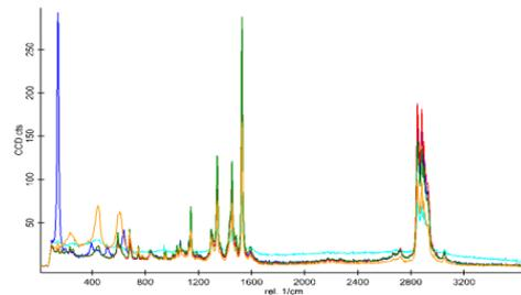
Figura 3. Espectro Raman del polímero de la bolsa de banana.
