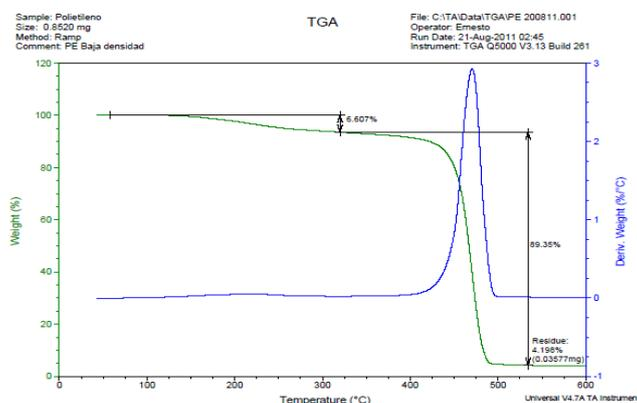
Figura 5. Análisis TGA de Bolsa de banano
