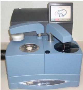
Figura 7. Equipo para Barrido Calorimétrico por Escaneo Diferencial
