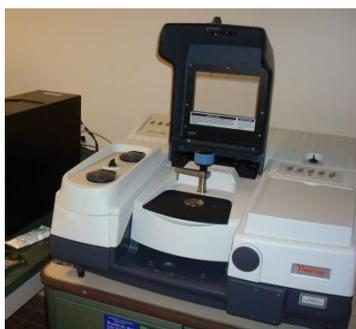
Figura 13. Equipo para Espectrometría Infrarroja
