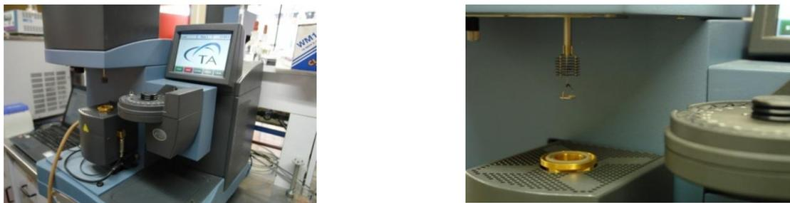
Figura 4. Equipo para Análisis Termogravimétrico (Fuente: LanammeUCR)
