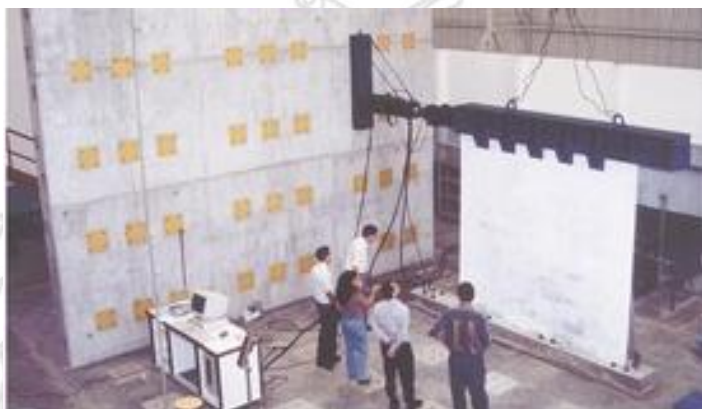
Figura No. 3 Muro de reacción y piso fuerte para ensayos a escala natural.
