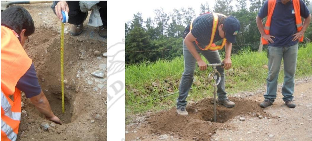
**Fotografía N°10. Revisión de estructura de pavimento existente realizada por funcionarios del LanammeUCR.**
