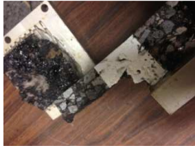
(a) 1200 ciclos al 93% de reducción de la carga, geotextil a la altura media
