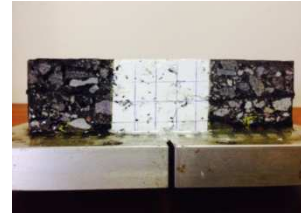
(c) 2000 ciclos al 99% de reducción de la carga, geotextil a la altura media
