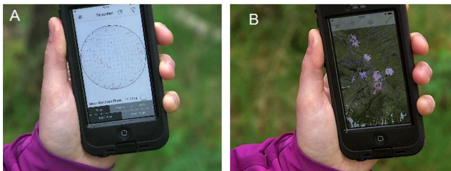
Figura 2. A.) Visualización de datos en red estereográfica. B.) Visualización de ubicación de datos en imagen satelital. (Imágenes cortesía de Midland Valley Exploration Ltd).
