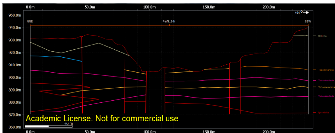
Figura 5. Perfil estratigráfico generado a partir de información de perforaciones y la topografía lidar.
