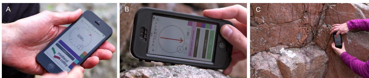
Figura 1. A.) Toma de datos de rumbo con brújula durante navegación. B.) Toma de datos lineales C.) Toma de diaclasas en afloramiento. (Imágenes cortesía de Midland Valley Exploration Ltd).
