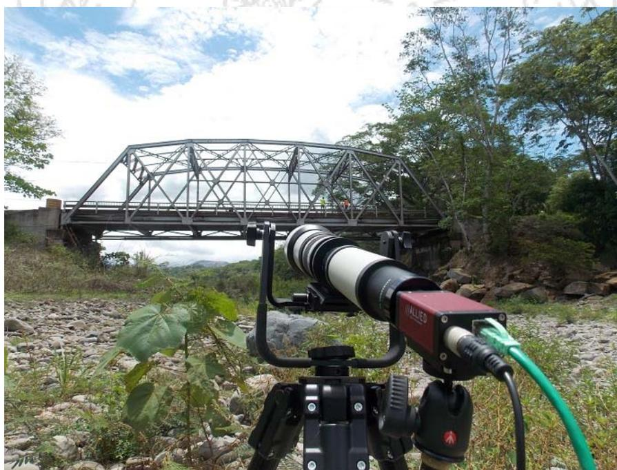
**Figura 6.** Sistema de medición de desplazamiento siendo utilizado en el puente sobre el río seco en Ruta Nacional 1.
