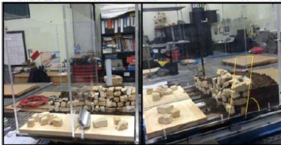
**Figura 13.** Proceso constructivo de los modelos a escala de las estructuras de escollera sobre las mesas vibratorias. Tomado de la referencia 8.
