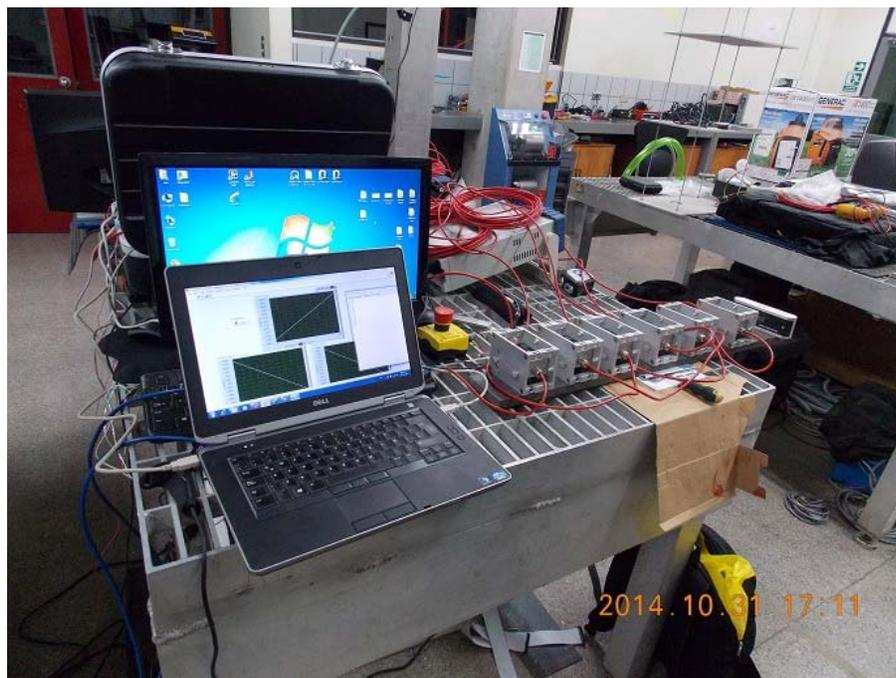
**Figura 3.** Pruebas de validación de los inclinómetros utilizado en el proyecto de monitoreo de puentes en sitio.
