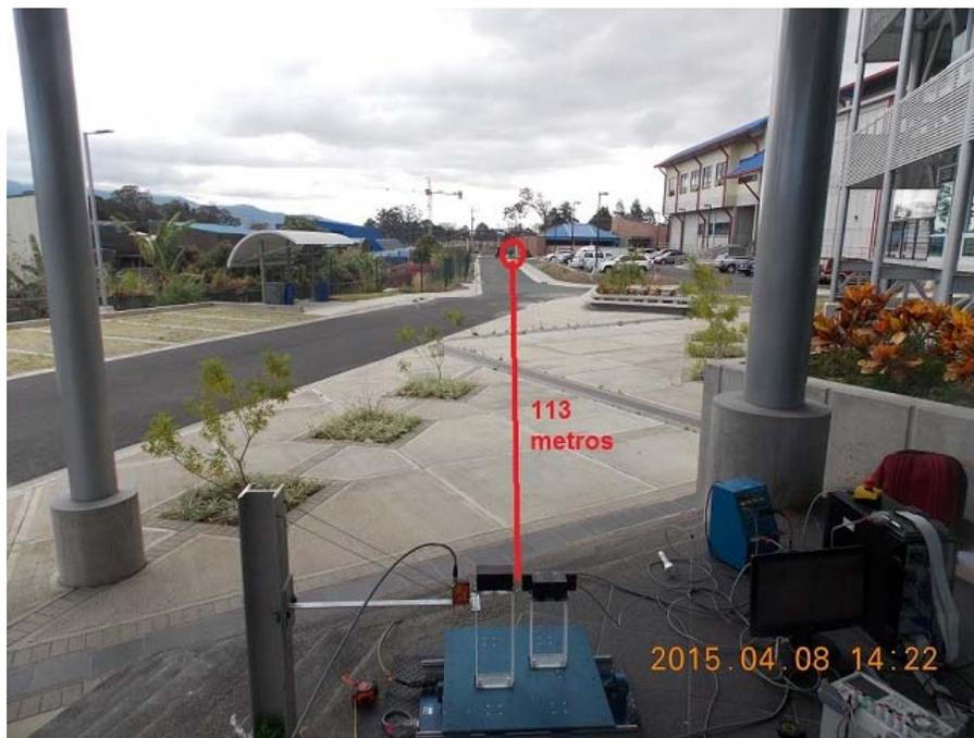
**Figura 5.** Pruebas de validación de medición de desplazamientos utilizando análisis de imagen utilizando las mesas vibratorias en las instalaciones de la UCR.
