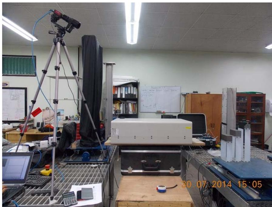
**Figura 4.** Pruebas de validación de medición de desplazamientos utilizando análisis de imagen utilizando las mesas vibratorias en el laboratorio a escala reducida.
