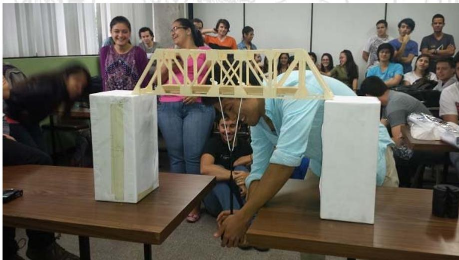
**Figura 11.** Estudiantes del curso de Mecánica del Sólido 2 durante la falla de un puente tipo cercha construido con cartón (primer semestre 2015).
