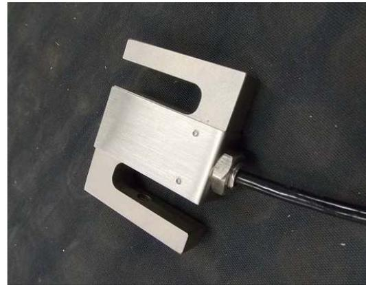
**Figura 3.-** Celda de carga.
