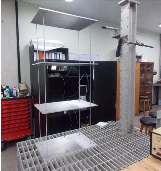
Figura 10.- Modelo tridimensional de 9 grados de libertad.
