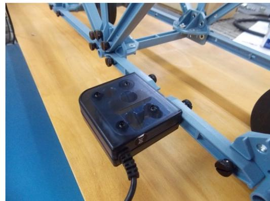
**Figura 9.-** Celda de carga ubicada en el puente tipo cercha.
