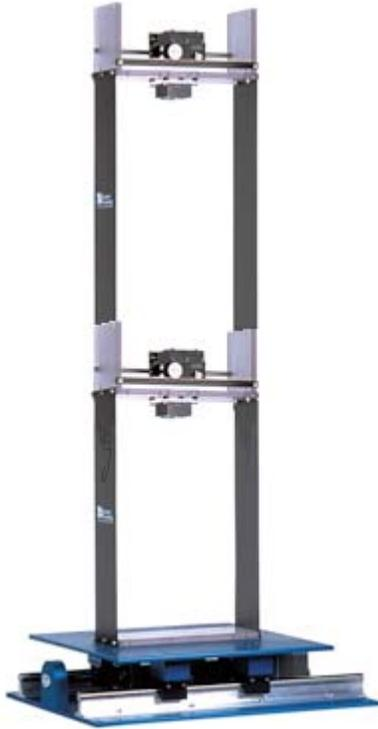
**Figura 5.-** Modelo de 2 grados de libertad con amortiguamiento activo o pasivo (Quanser, 2014).
