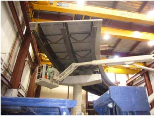
**Figura 23.-** Modelo experimental a escala 0,40 de un puente curvo
