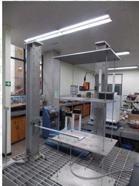
**Figura 15.** Colocación del modelo y sensores para medición de K2
