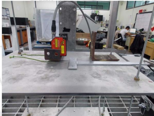
**Figura 13.** Colocación del láser y del blanco
