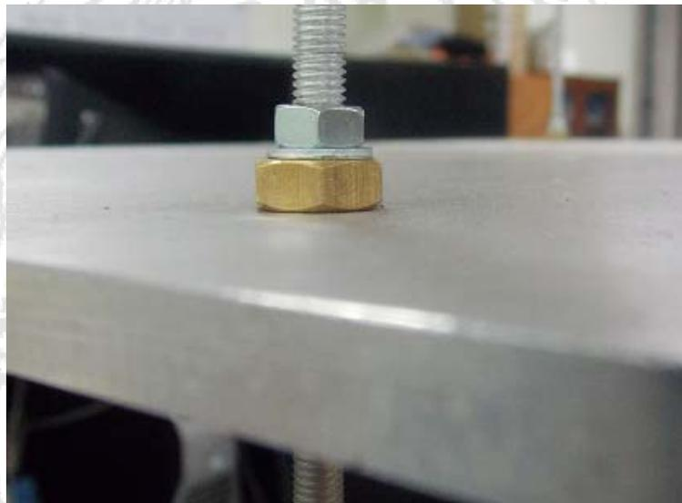
**Figura 2.** Detalle de conexión entre la placa y la barra roscada
