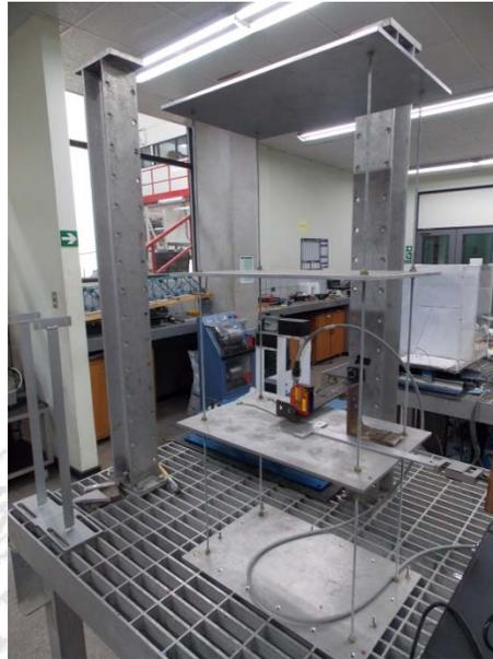
**Figura 14.** Colocación del modelo y sensores para medición de K1
