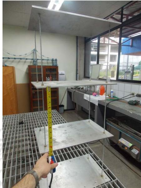
**Figura 7.** Medición del espaciamiento entre placas del modelo
