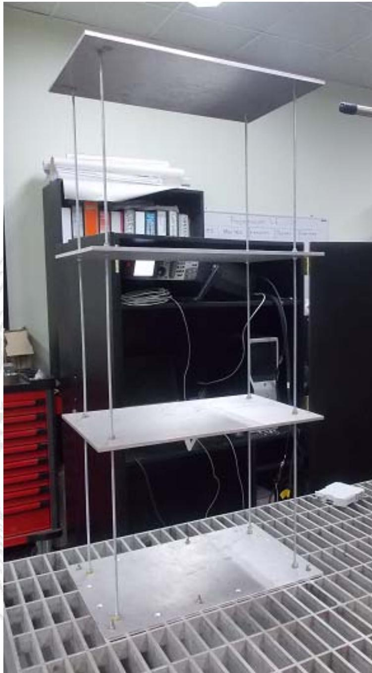
**Figura 3.** Modelo tridimensional anclado a la mesa de pruebas
