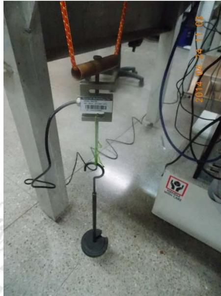
**Figura 12.** Calibración de la celda de carga
