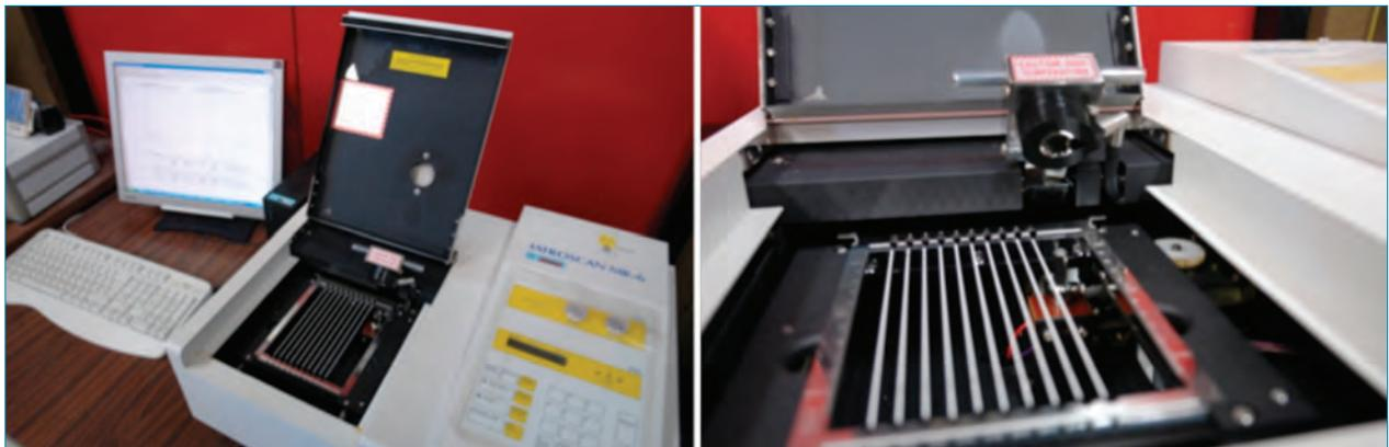
Figura 8. Equipo para Cromatografía latroscan (Fuente: LanammeUCR).
