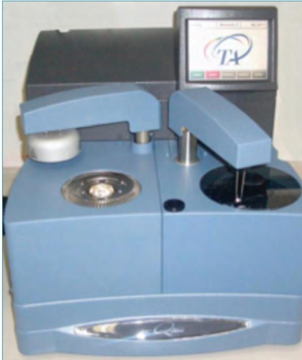
Figura 6. Equipo para Barrido Calorimétrico por Escaneo Diferencial.
