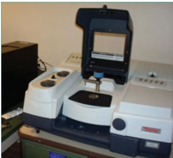
Figura 11. Equipo para Espectrometría Infrarroja.
