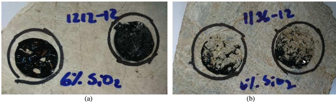
Figura 6. Falla por (a) cohesión (Caliza 2) y por (b) adhesión (Caliza 1) con asfalto modificado con 6% SiO<sub>2</sub>
