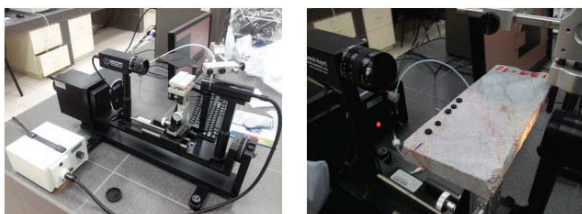
Figura 7. Goniómetro/Tensiómetro. Fuente: Lanotec, CeNAT.
