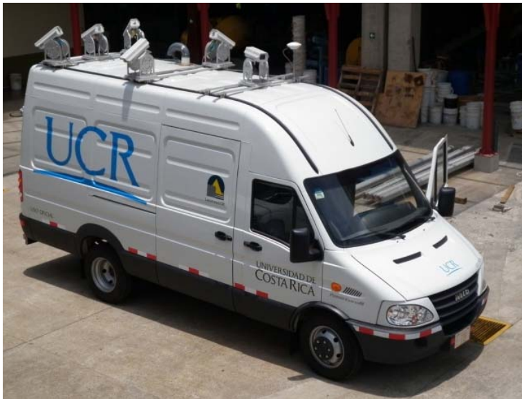
Figura 6. Equipo Geo-3D con cámaras de alta resolución, LanammeUCR.
