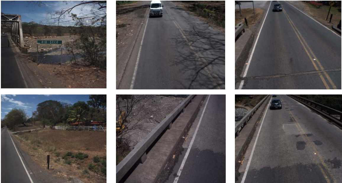
Figura 9. Varias vistas obtenidas con el equipo Geo-3D, a través de las cuales se pueden evaluar los elementos y condiciones de seguridad vial de un puente y sus accesos. (UGERVN, LanammeUCR, 2012)
