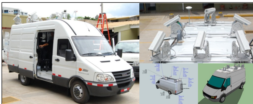
Figura 9: Vehículo del LanammeUCR equipado con el equipo Trimble GEO 3D
