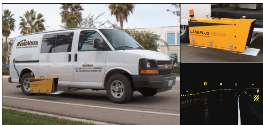
Figura 8: Equipo Laser para medición de retrorreflectividad (LaserLUX CEN 30)
