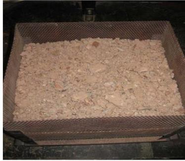
**Figura 3. Agregado RAP obtenido del horno de ignición**
