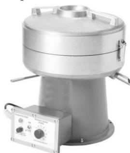
**Figura 1. Tazón de extracción con centrifuga**
